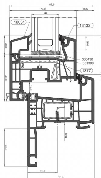
**Cortizo 70** è progettato con un telaio e anta di spessore 70 mm e 5 camere, sia nell'anta che nel telaio, offrendo un elevato livello di comfort termico e acustico all'interno dell'abitazione. La sua composizione chimica innovativa garantisce prestazioni meccaniche ed estetiche superiori, assicurando resistenza e durabilità nel tempo.
